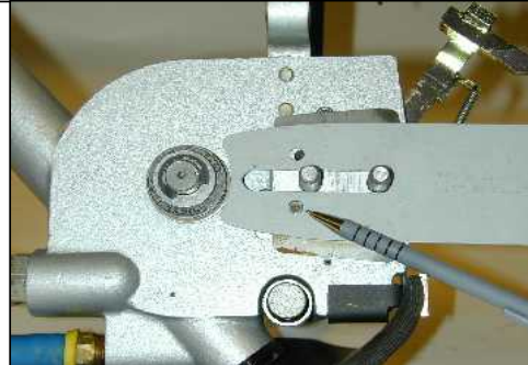
Fase 2: Posizionare la barra sui prigionieri e sul perno di regolazione della catena.
