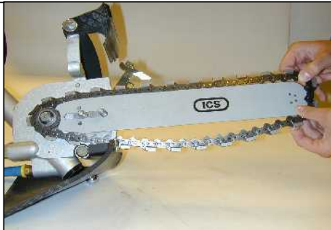
Fase 4: Montare la catena sulla barra, partendo dal rochetto di azionamento e continuare sulla punta della barra.
