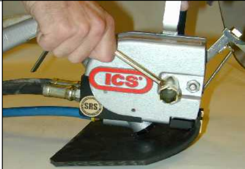
Fase 1: Allentare i dadi della protezione laterale e rimuovere la protezione.
