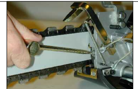
Fase 5: Assicurarsi che tutte le maglie di azionamento si trovino all'interno della scanalatura della barra e successivamente pretensionare la catena.
