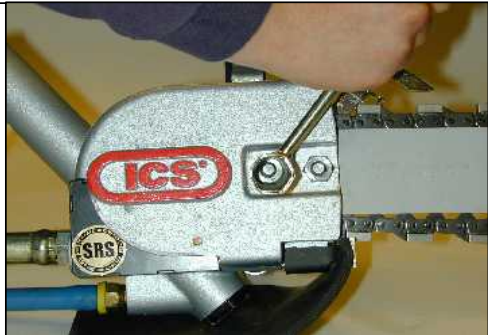
Fase 8: Continuare a sollevare la punta della barra e stringere saldamente i dadi della copertura laterale. Ved.nota 3.
