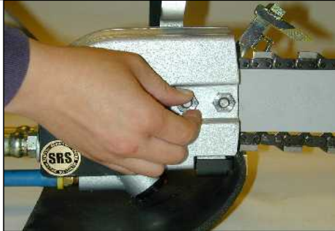
Fase 6: Installare la copertura laterale e infilare i dadi della copertura laterale sui nottolini stringendoli.
